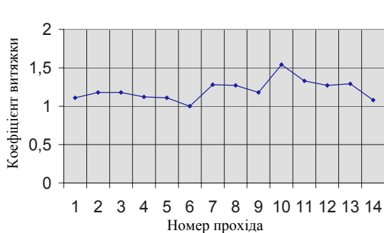
Рис. 3. Параметри прокатки профілю башмака із кроком 260 мм
